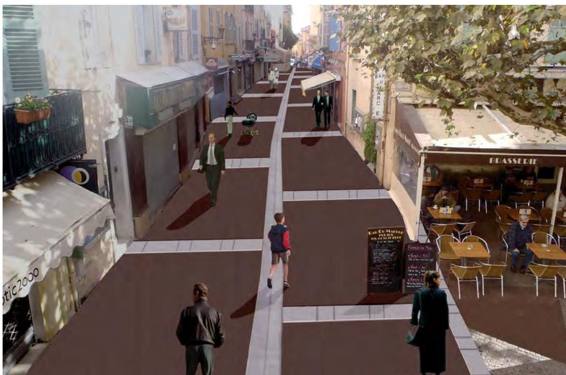
*Un caniveau central, des dalles apposées perpendiculairement et un calepinage de 25 à 30 m<sup>2</sup> rempli d'enrobé rouge, telle sera la nouvelle physionomie de la rue Sieyès pour la Bravade (19-22 avril) : ces travaux entrent dans le cadre du projet de rénovation du cœur historique mené depuis plusieurs années maintenant*
