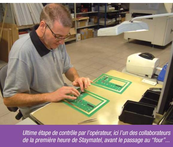
*Ultime étape de contrôle par l'opérateur, ici l'un des collaborateurs de la première heure de Staymatel, avant le passage au "four"...*
