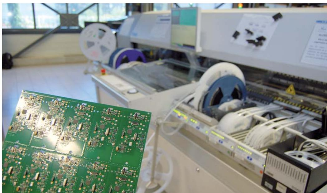
*Voici une planche de dix cartes électroniques, produites en série, à la sortie d'une des trois machines de report à plat, capable de poser quelque 20.000 composants à l'heure. Cette planche passe ensuite dans le four à refusion (de 6 zones de chauffe) afin de souder les composants sur le support*
