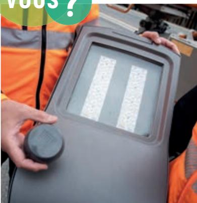
Ci-dessus, gros plan sur une lanterne LED et son module de communication GPRS qui permet de connecter la lanterne au réseau de supervision de la ville.
