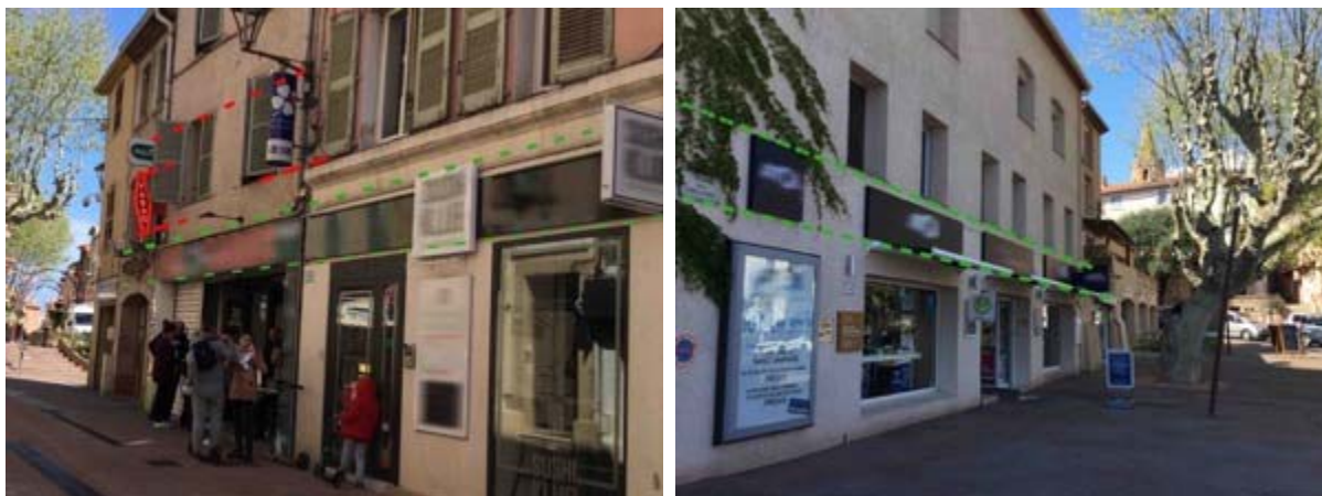
Alignement des enseignes, à gauche enseignes perpendiculaires non alignées et fixées au-dessus du premier niveau du bâtiment, à droite alignement des enseignes – Fréjus, avril 2019
