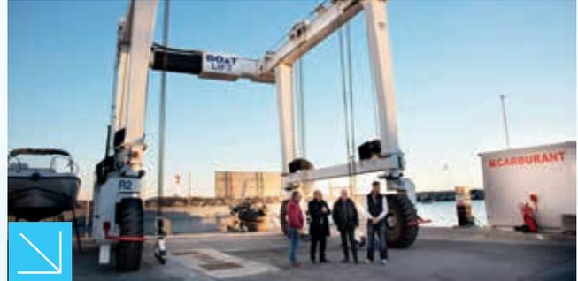
Répartie sur 8000 m<sup>2</sup>, le CNPF accueille environ 650 « bâtiments » par an, à voile ou à moteur, grâce à un engin de levage et remise à l'eau de bateaux jusqu'à 75 tonnes, pouvant mesurer 22 m de long et 6 m de large.
