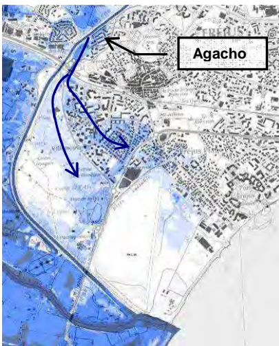
Crue de référence du Reyran avec rupture de digue
