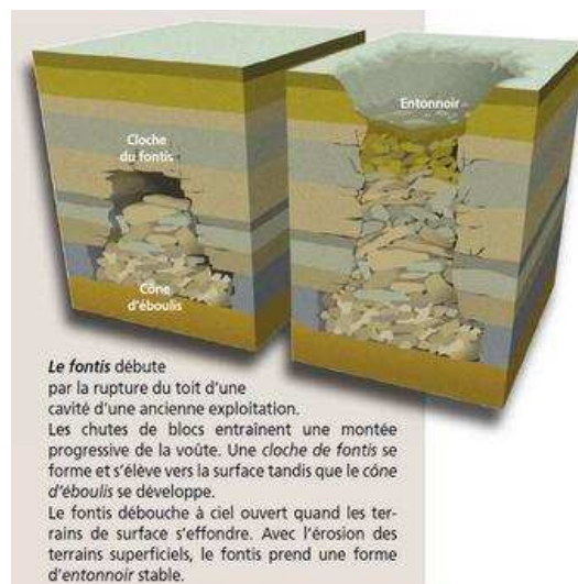
Illustration du phénomène d'effondrement localisé
