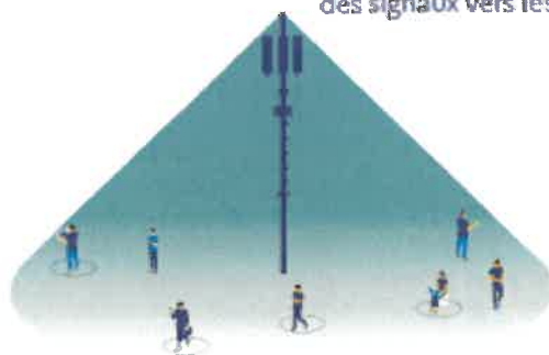
Antenne passive 2G | 3G | 4G | 5G sans système d'émission et réception directionnel des signaux fréquences < 10GHz
