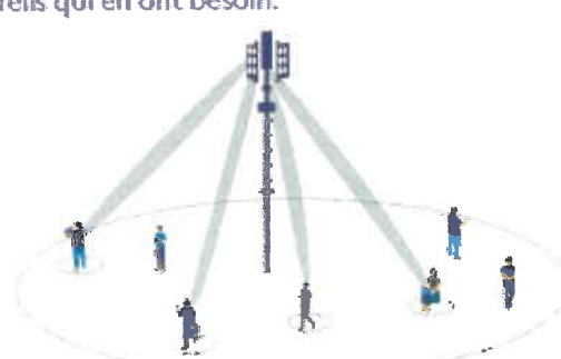
Antenne active 5G avec système d'émission et réception directionnel des signaux fréquences > 10GHz
